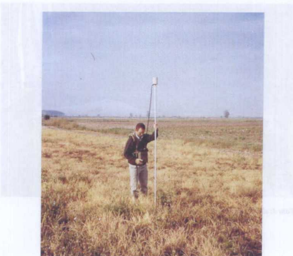
Foto 2: medición del campo magnético, previa a la realización del SRM, con un magnetómetro de protones
